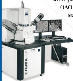
Микроскоп Zeiss SIGMA VP обладает эффективным увеличением до 1 000 000 раз с разрешением до 1,3 нм.
